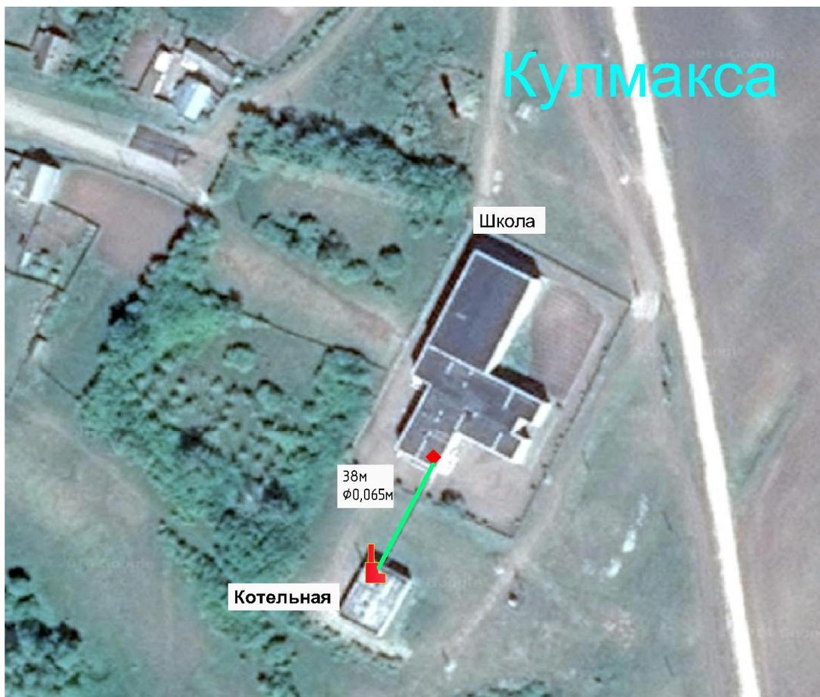
**Рисунок 3-3. Схема тепловых сетей от котельной «Школа» в н.п. Кулмакса**
