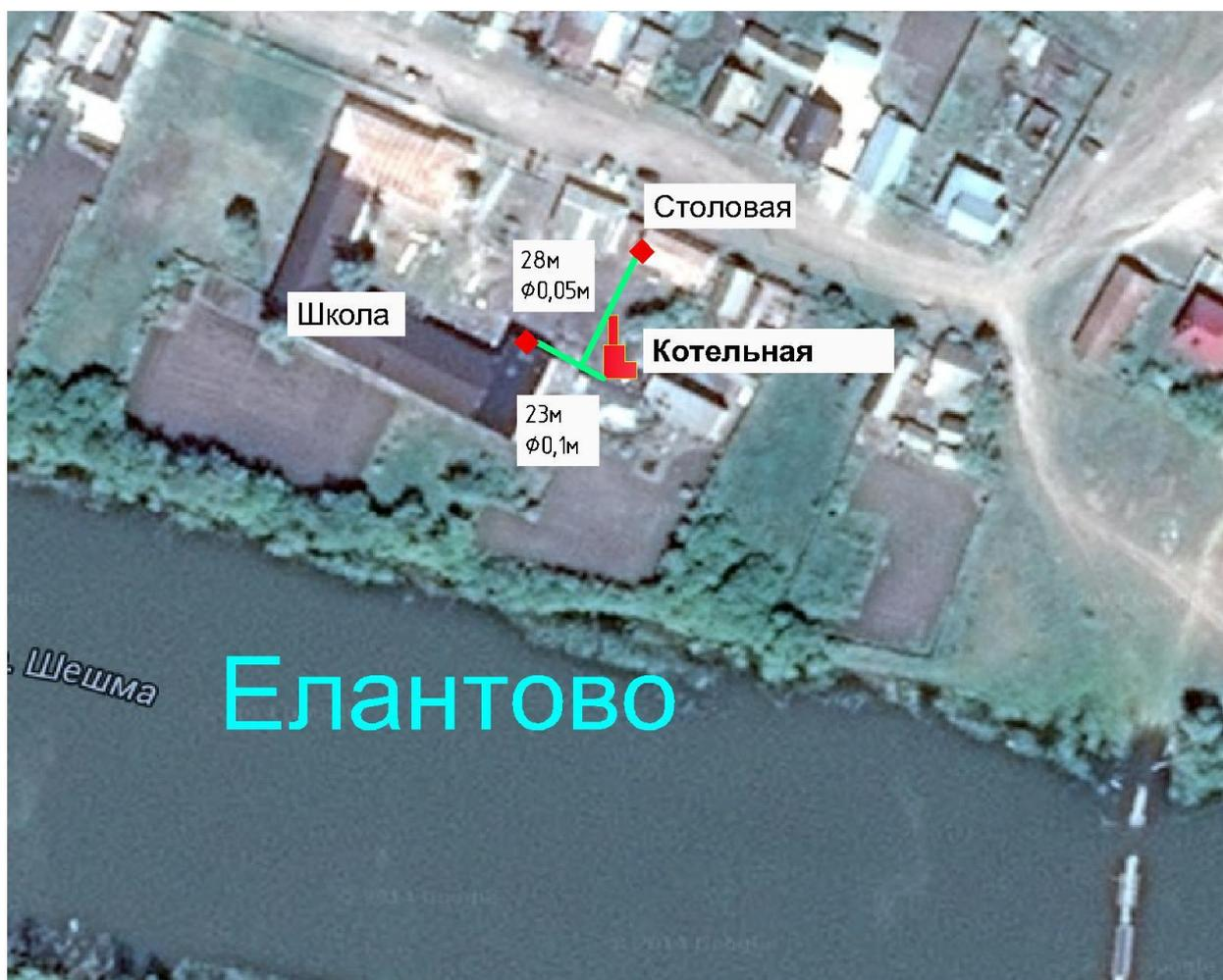
Рисунок 3-1. Схема тепловых сетей от котельной «Школа» в н.п. Елантово
